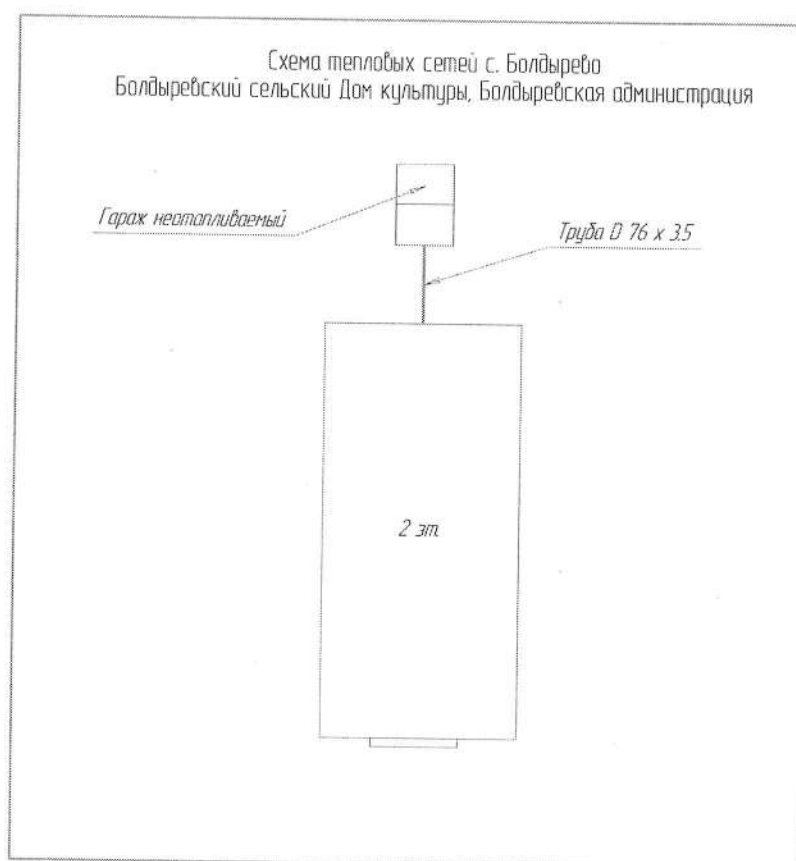
Рисунок 4.5 – Схема теплоснабжения Болдыревского СДК
