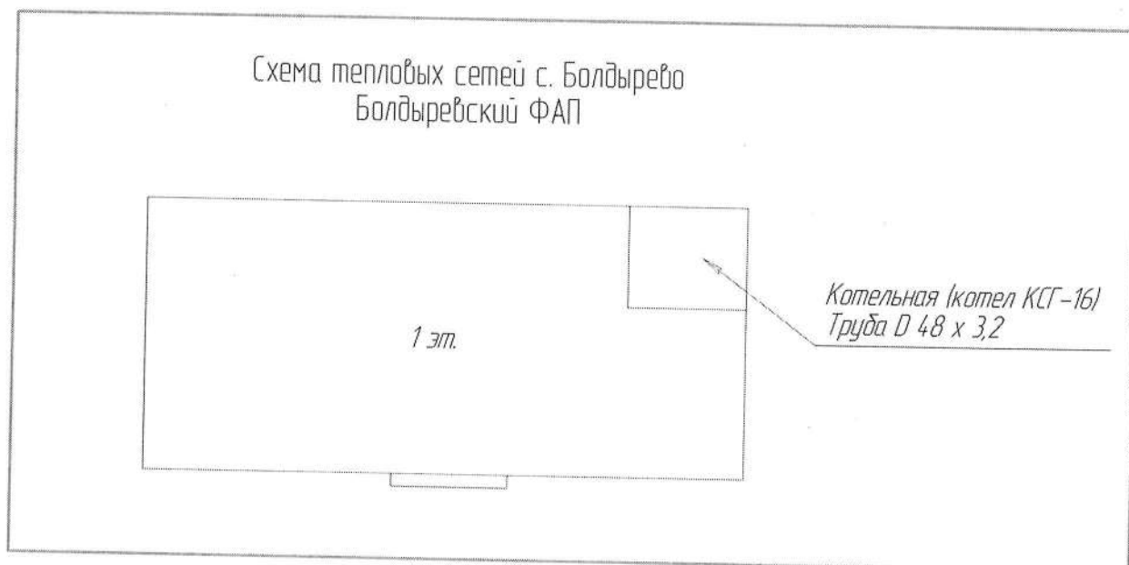
Рисунок 4.6 – Схема теплоснабжения Болдыревского ФАПа
